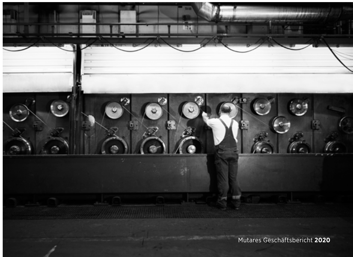
Mitarbeiter, der eine Maschine kontrolliert, die Kupferdraht durch Verlängerung dünner macht
