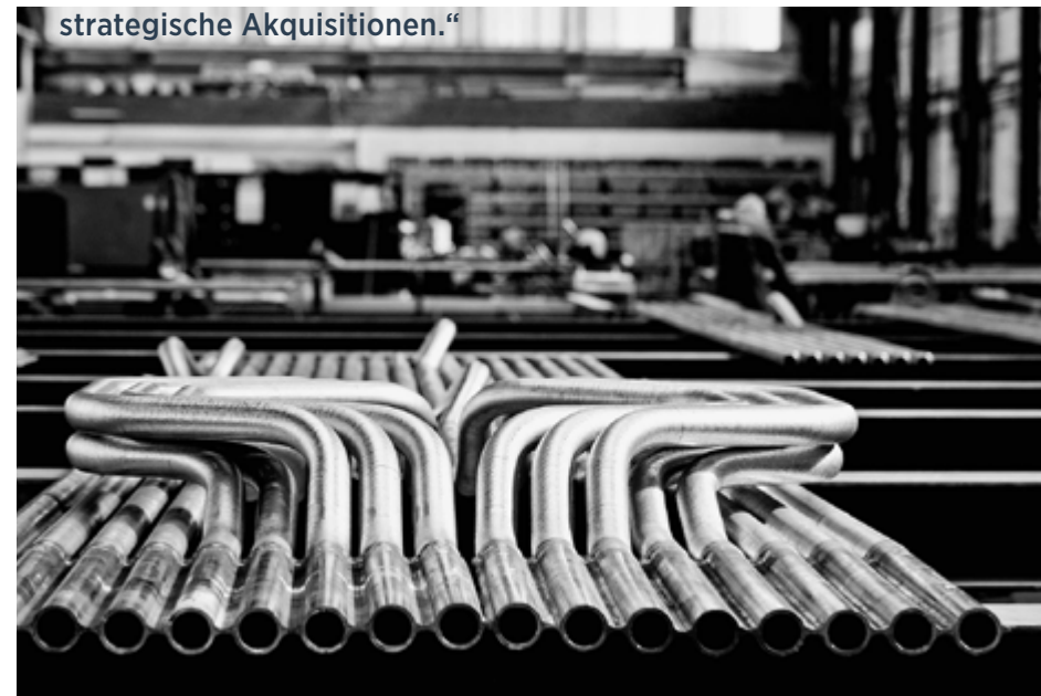
Rohrausbiegungen als Teil eines Austauschs von Kesseldruckteilen
