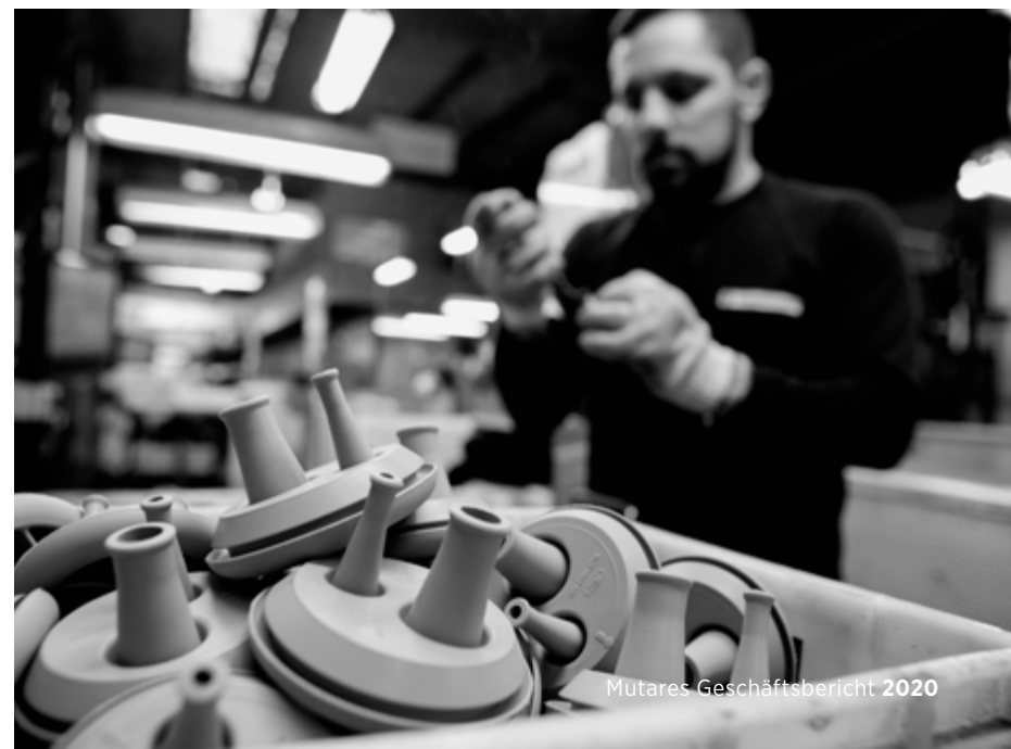
Abschließende Qualitätsprüfung einer Armaturenbrett-Durchführung
